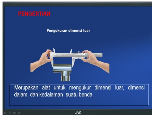
Gambar 11. Slide Materi Vernier Caliper Pengukuran Dimensi Luar
