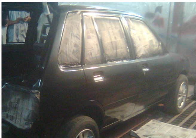
Gambar 29. Hasil setelah pengaplikasian cat warna
