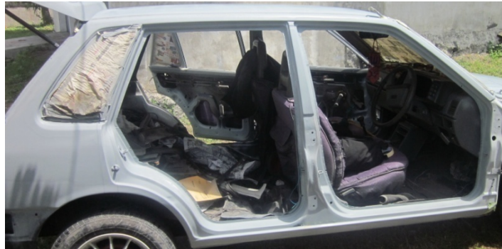
Gambar 28. Hasil setelah pengaplikasian surfacer
