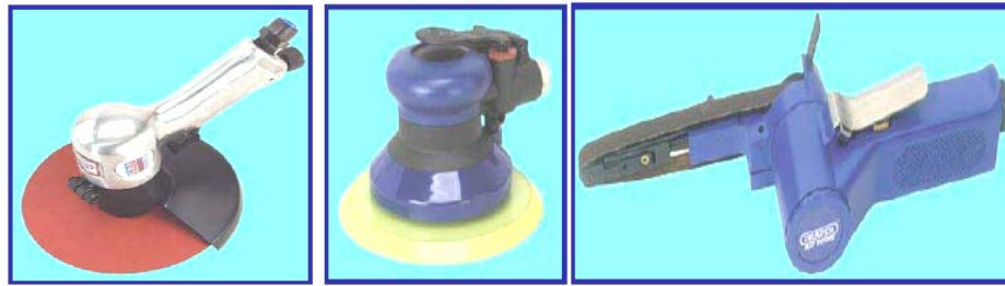
Gambar 3. Sander Elektrik dan Sander Pneumatik (Gunadi, 2008: 460)
