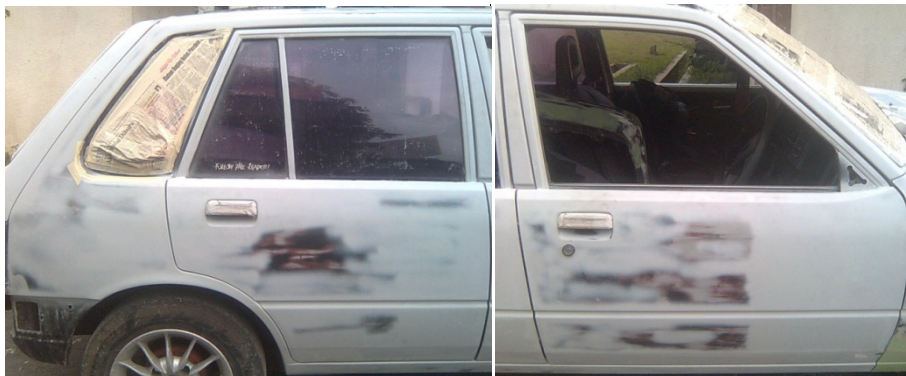
Gambar 27. Hasil setelah pengaplikasian epoxy primer
