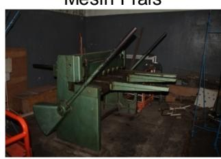
Mesin Pemotong Plat
