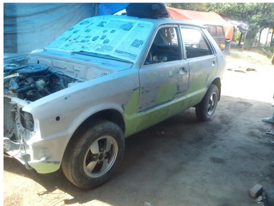
Gambar 37. Masking pada Kaca Depan
