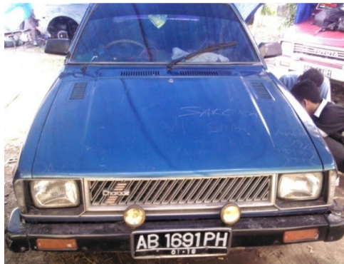
Gambar 32. Kerusakan Permukaan pada Kap Mesin
