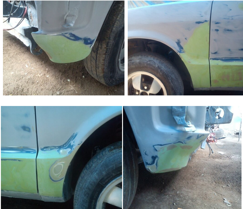
Gambar 36. Proses Aplikasi Putty Bagian Fender
