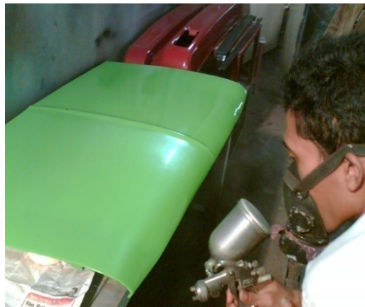
Gambar 73. Proses pengecatan akhir ( top coat )
