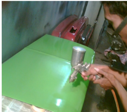
Gambar 74. Proses pelapisan clear
