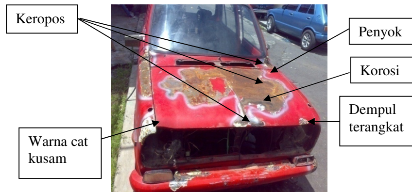
Gambar 65. Kerusakan kap ( engine hood ) sampai dudukan kaca
