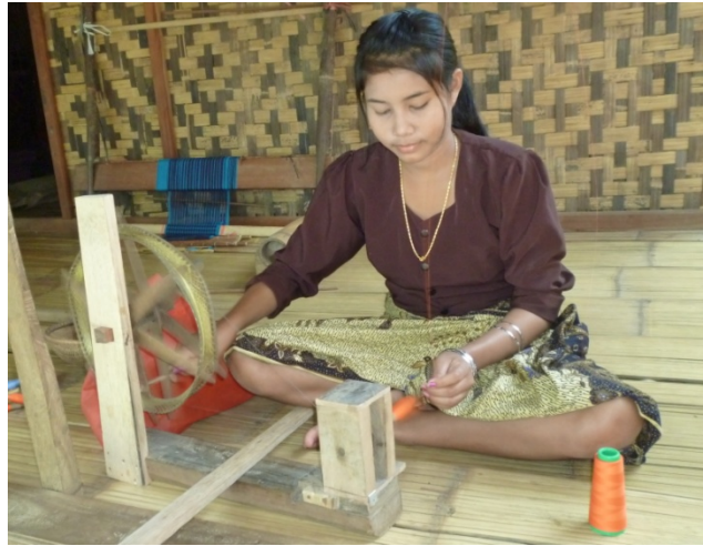
Gambar 46: Proses Menggulung Benang (Sumber : Dokumentasi Anita Dwi Astuti, 15 Juli 2012)
