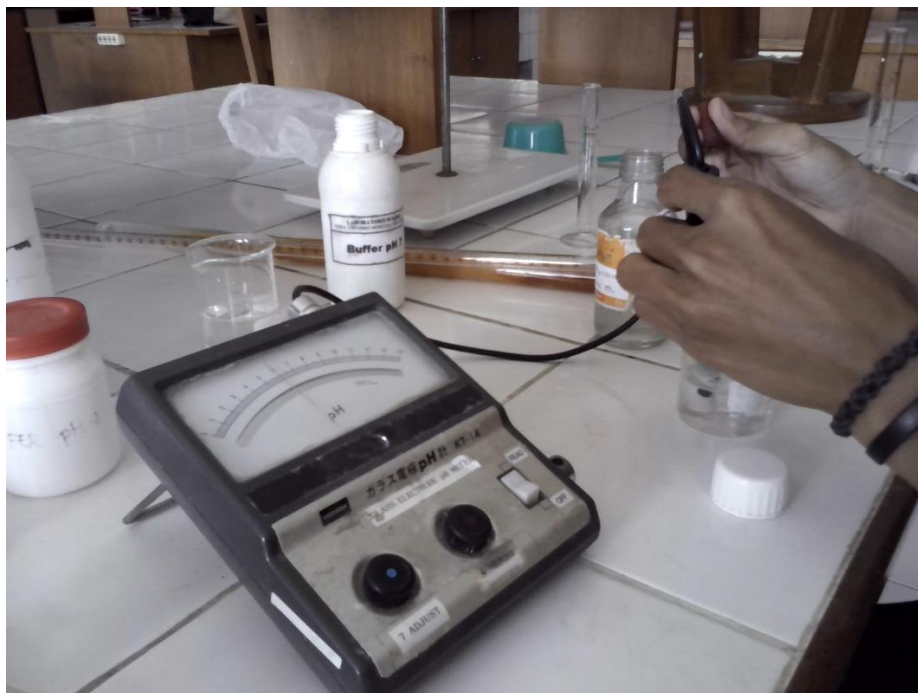
pH meter untuk analisis pH ekstraktan
