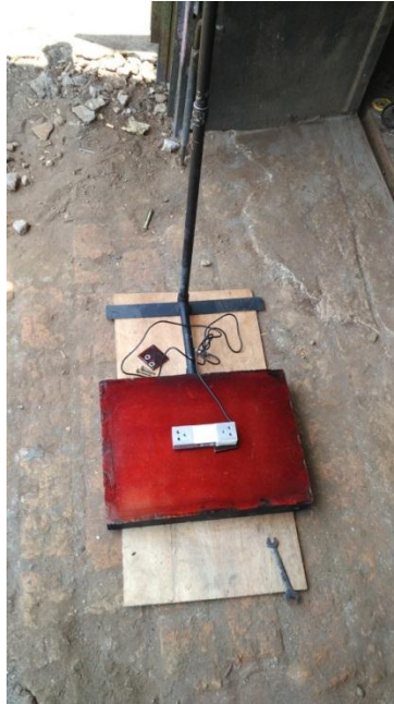
Gambar 42: Alat Ukur Tinggi Badan dan Berat Badan Saat Pemberian Bingkai Lantai Alas Timbangan (Sumber: Dokumen Pribadi)
