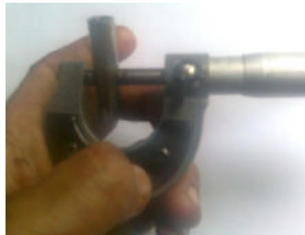
Gambar32. Mengukur diameter luar poros pelatuk
