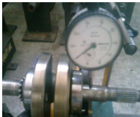
Gambar 45. Mengukur kebengkokan poros engkol
