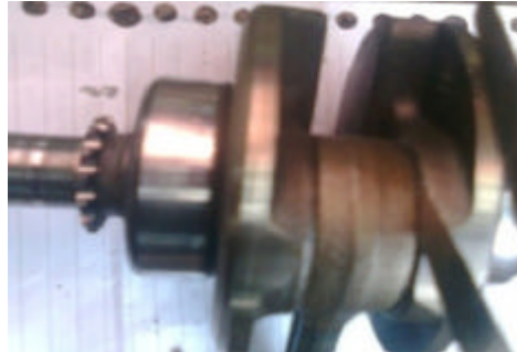
Gambar 43. Mengukur jarak kerenggangan aksial kepala besar poros engkol
