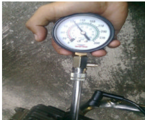
Gambar 47. Mengukur tekanan kompresi
