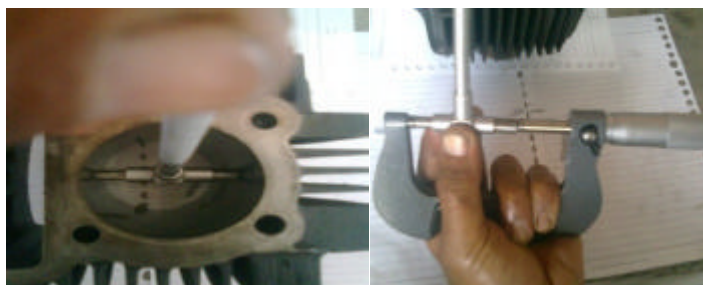
Gambar 39. Mengukur diameter dalam blok silinder
