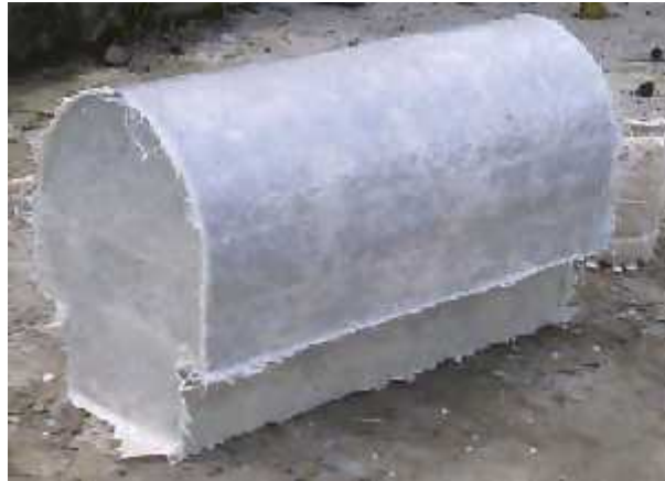
Gambar 19. Molding yang Telah Dilapisi Fiberglass
