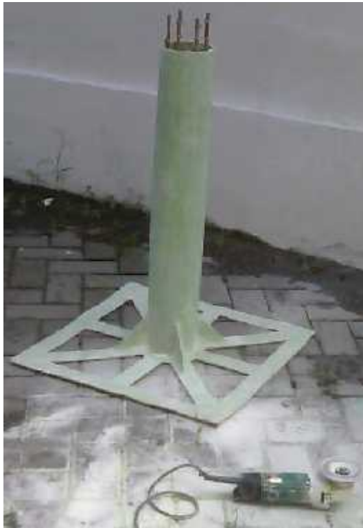
Gambar 20. Proses Merapikan Komponen dari Fiberglass
