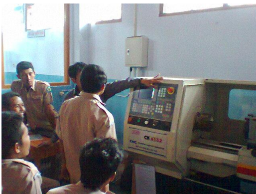
Gambar penjelasan tentang mesin bubut CNC dan Bagian-bagian utamanya
