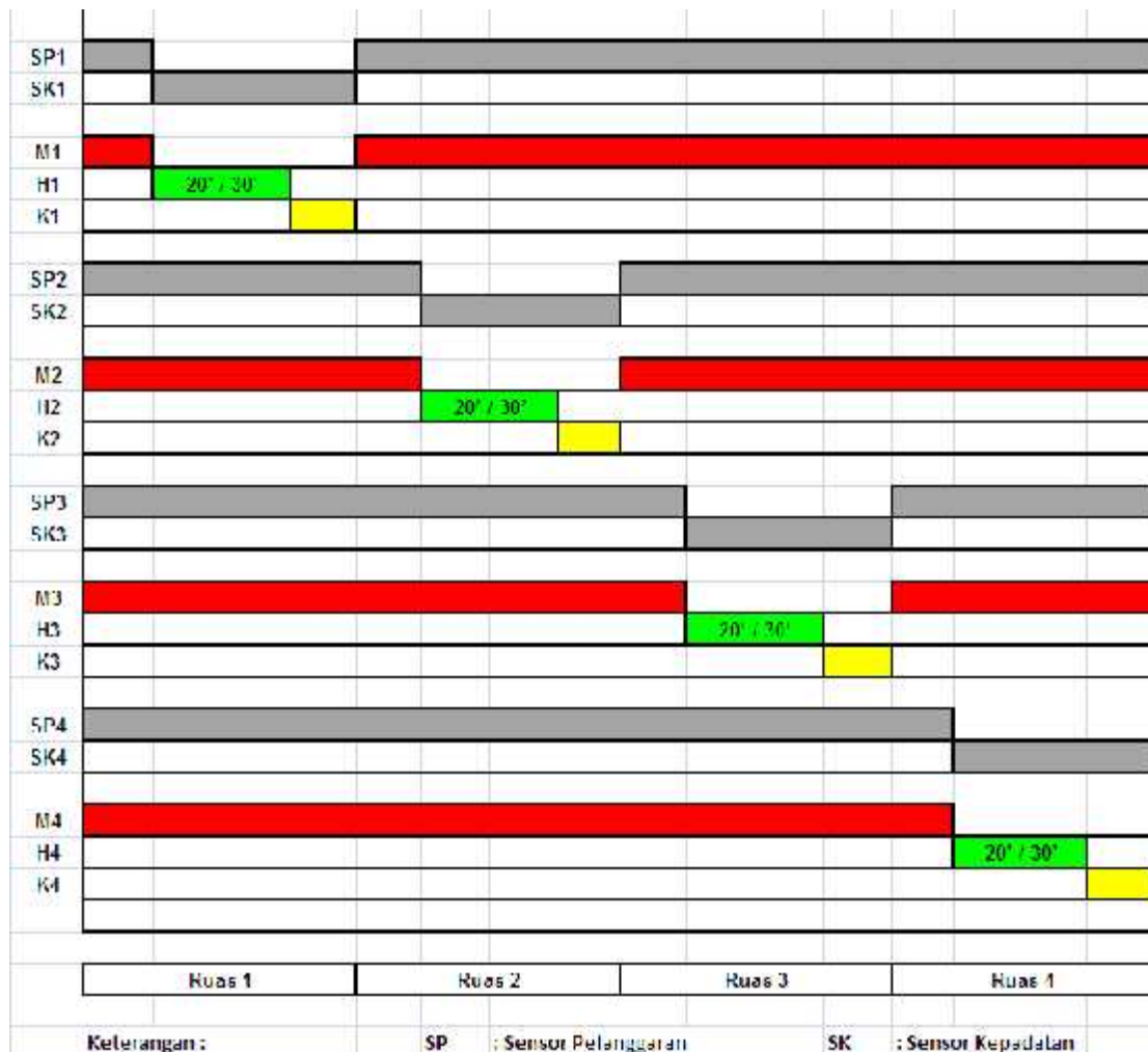
Gambar 12. Diagram Pewaktuan Deteksi Pelanggaran pada Smart Traffic Control System
