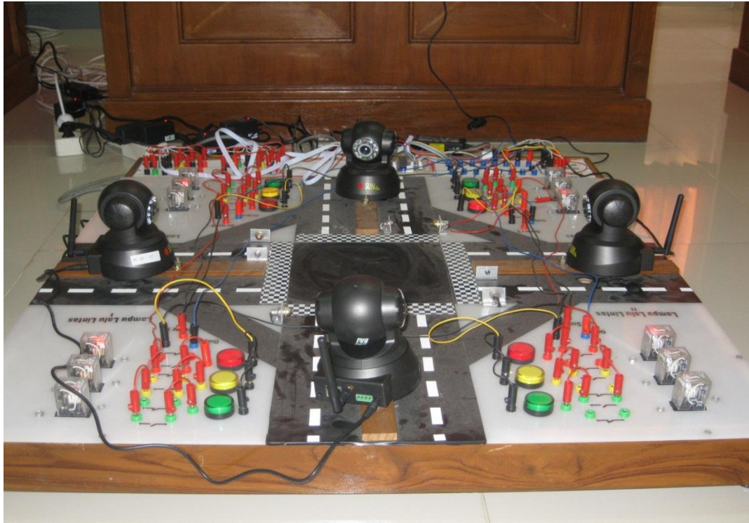
Gambar 8. Perangkat Keras Deteksi pelanggaran lampu lalu lintas 4 jalur
