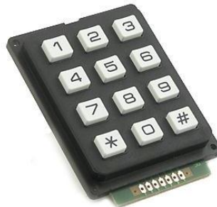
Gambar 10. Bentuk Fisik Keypad 4×3 (Sumber : Ari Heryanto, M dan Wisnu Adi P, 2008)
