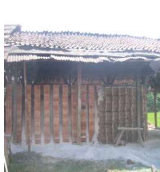
Gambar 3. Proses Pengeringan Batu bata Gambar 4. Proses Pembakaran Batu Bata
