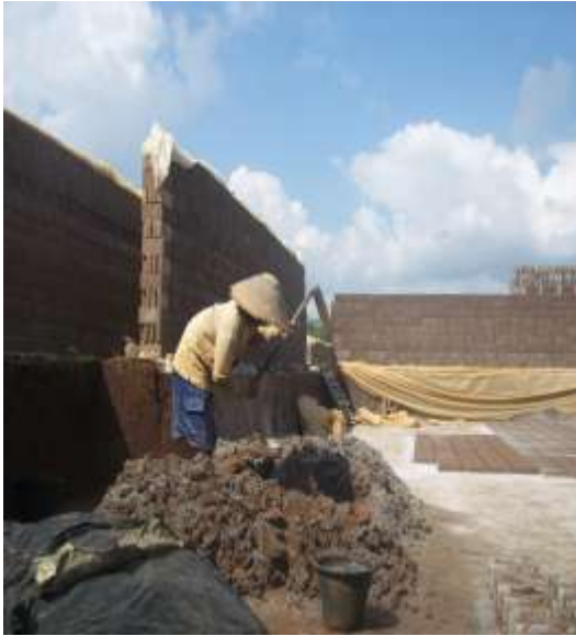
Gambar 1. Proses Pembuatan Adonan Batu Bata Gambar 2. Proses Pencetakan Batu Bata
