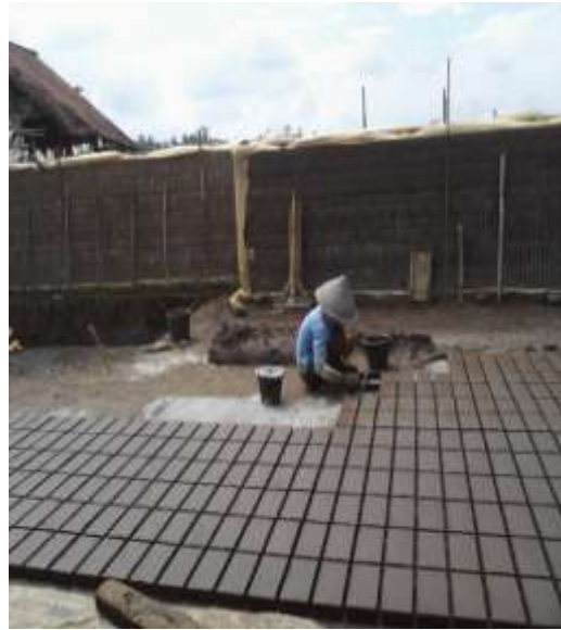
Gambar 1. Proses Pembuatan Adonan Batu Bata Gambar 2. Proses Pencetakan Batu Bata
