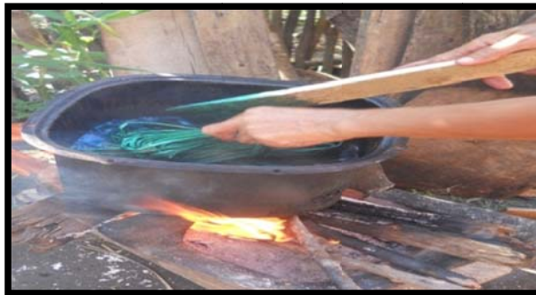
Gambar 27: Proses Pewarnaan Membolak-balik Purun (Dokumentasi: Siska Angraini, 2013)
