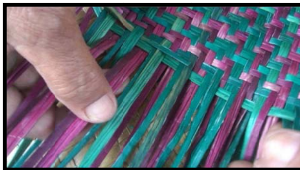
Gambar 30: Proses Menganyam Purun menjadi Tikar
