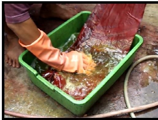
Gambar 32: Pencelupan pada Larutan Napthol (Sumber: Dokumentasi Irsan Aditya, Maret 2013)
