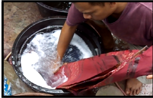
Gambar 31: Pencelupan pada Air Deterjen (Sumber: Dokumentasi Irsan Aditya, Maret 2013)
