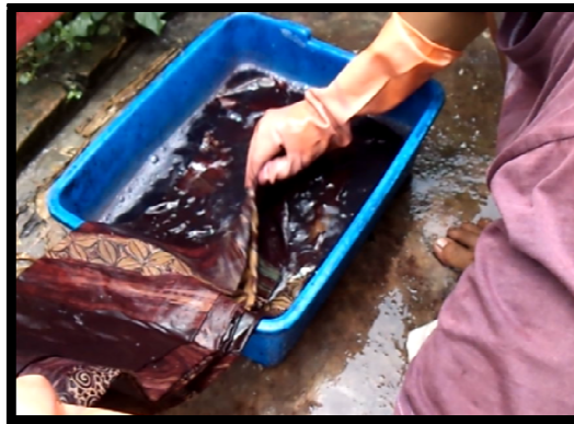
Gambar 33: Pencelupan pada Larutan Garam (Sumber: Dokumentasi Irsan Aditya, Maret 2013)
