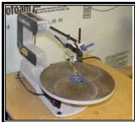
Gambar 11 : Mesin Sekrol Kecil (Sumber: Enget, dkk, 2008:347 )
