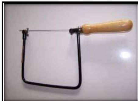
Gambar 14 : Sekrol Manual (Sumber: Enget, dkk, 2008:346 )
