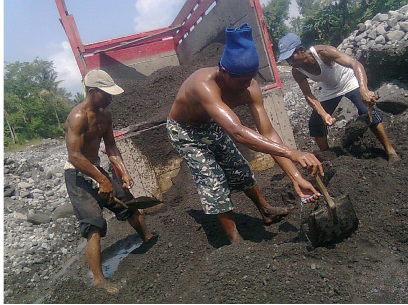
Gambar 7. Cara yang digunakan masih manual menggunakan serok dalam memindahkan pasir ke dalam truk. Diambil pada hari Sabtu, 26 Mei 2012.
