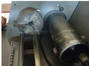
Gambar 15. Motor Utama Mesin bubut CNC TU-2A
