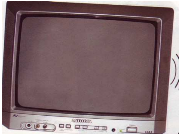
Gambar 6. Raster Tidak Ada Tapi Suara Baik
