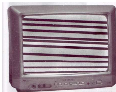
Gambar 12. Sinkronisasi Horizontal Jelek
