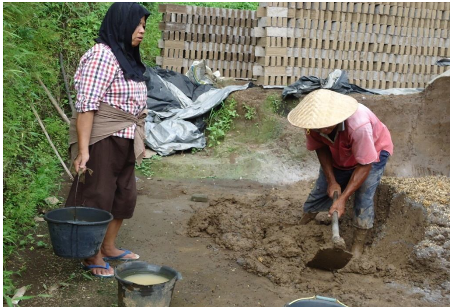
Proses Pembuatan Luluhan secara Manual (13 Februari 2014, Pukul 07.10 WIB)
