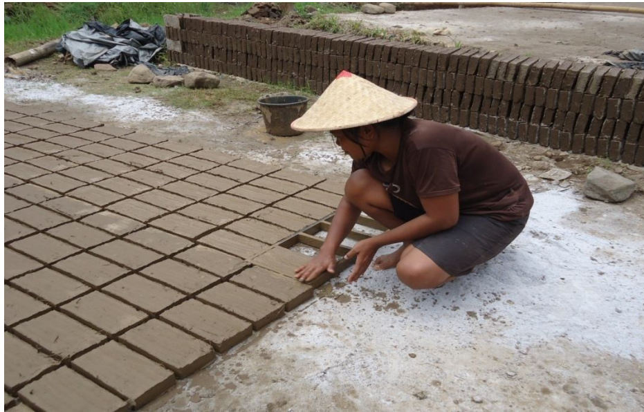
Proses Pencetakan yang dilakukan Ibu TS (13 Februari 2014, Pukul 08.00 WIB)
