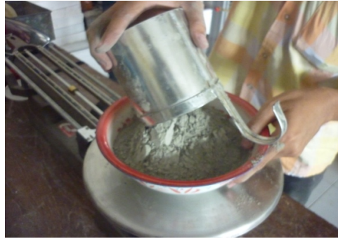
Gambar 17. Pengujian berat satuan semen dengan literan
