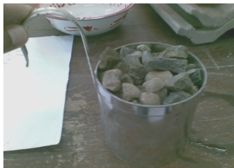
Gambar 16. Pengujian berat satuan kerikil dengan literan
