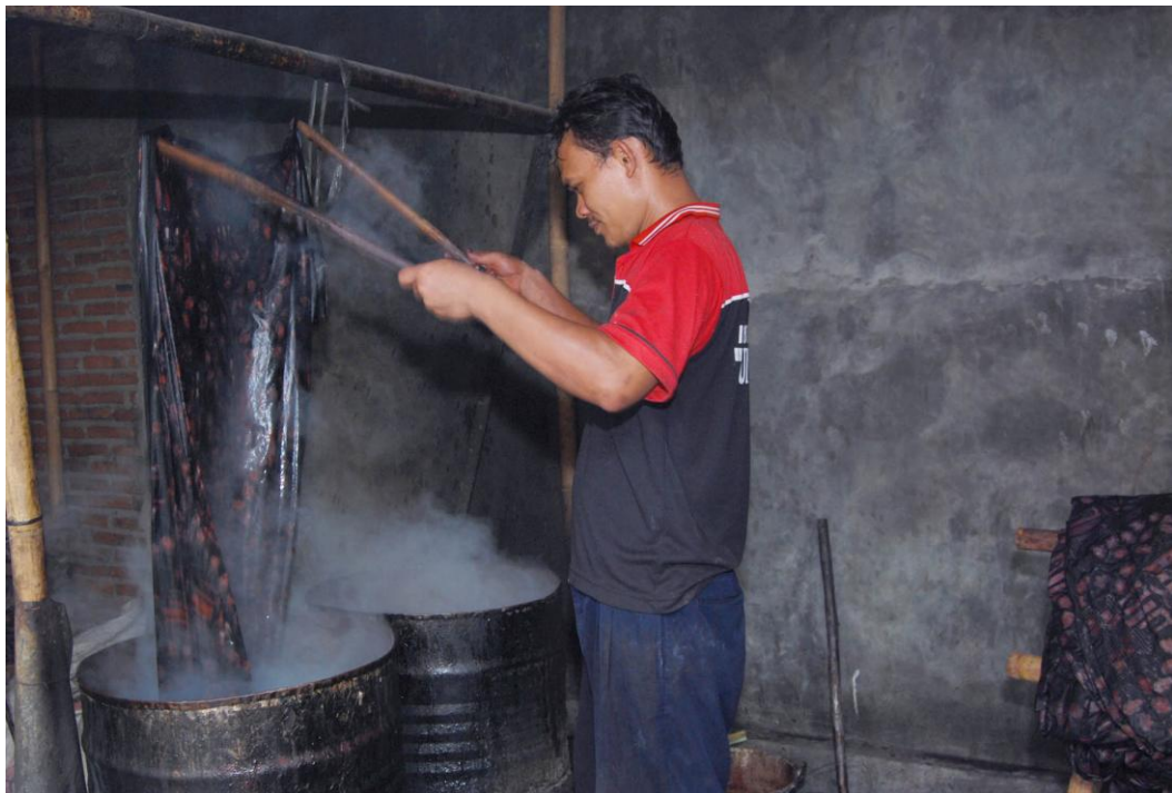
Gambar 84: Proses Pemanasan & Pelorotan Batik Dokumentasi (Devi, 2012)
