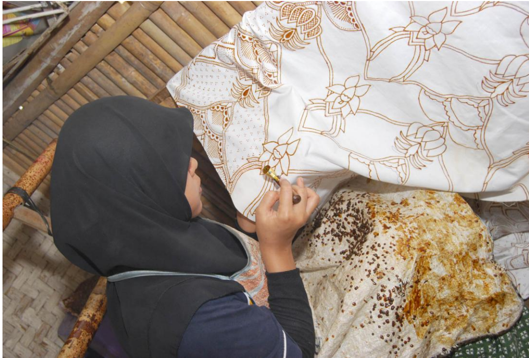
Gambar 77: Proses mencanting pola Dokumentasi (Devi, 2012)
