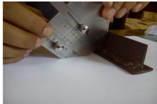
Gambar 10. Mengecek Hasil Las Siswa dengan Welding Gauge
