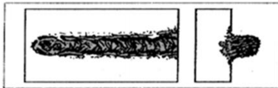
Gambar 6. Hasil Pengelasan Arus Terlalu Rendah
