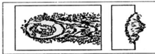
Gambar 7. Hasil Pengelasan Arus Terlalu Tinggi
