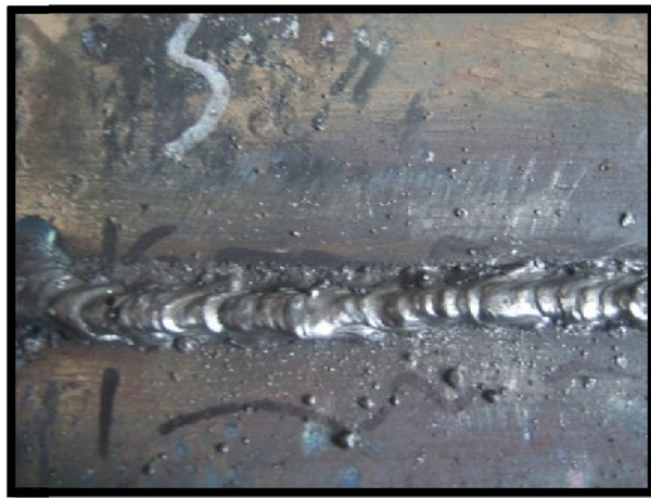
Gambar 10. Gambar Benda Kerja yang terdapat slag , smoke , dan spatter
