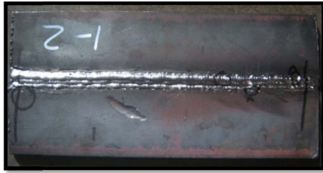
Contoh Hasil las Posisi 2G pada cover pass memenuhi kriteria
