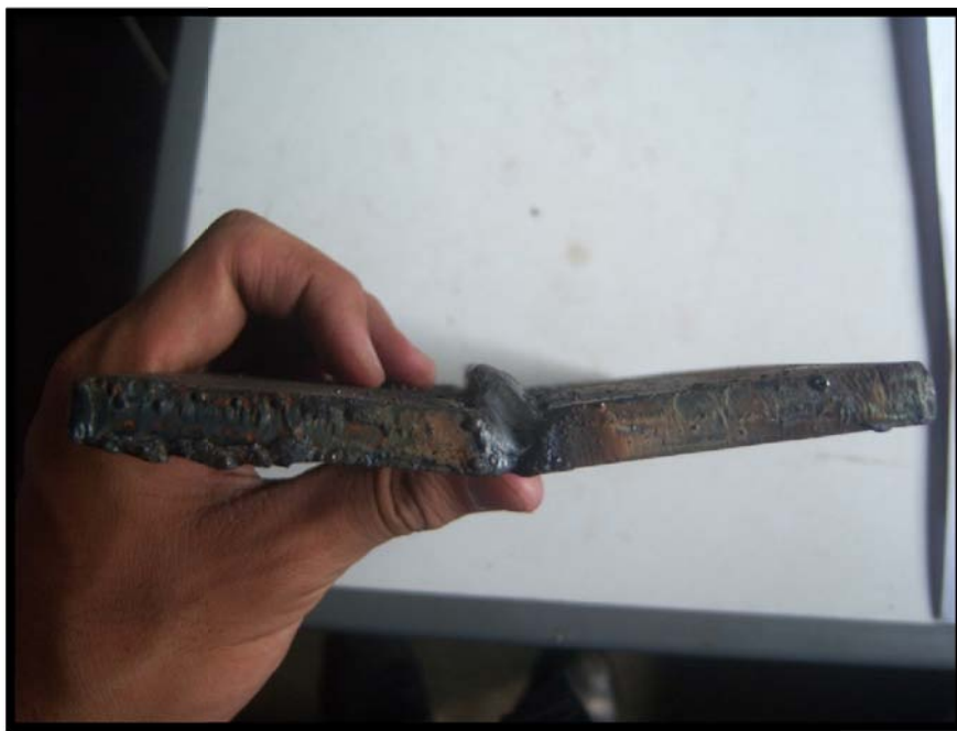
Contoh cacat las distorsi pada hasil Las Posisi 2G
