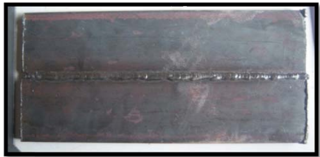
Contoh Hasil Las Posisi 2G pada root pass yang memenuhi syarat
