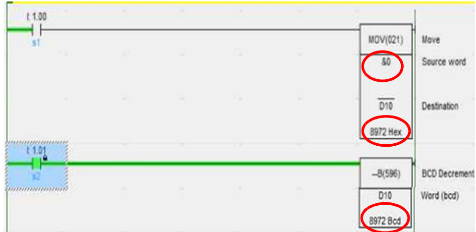
Gambar 10. Ladder Diagram Penggunaan Instruksi MOV Dari gambar diatas bisa dilihat cara kerja instruksi MOV, pada saat s2=1.01 aktif data memori D10=8972 . Apabila s1=1.00 di hidupkan maka data &0 (lihat lingkaran pada gambar 37) maka nilai data yang ada di D10 akan berubah menjadi 0, lihat gambar dibawah ini.
