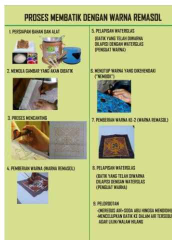
Gambar IX. Proses Membatik dengan Warna Remasol
