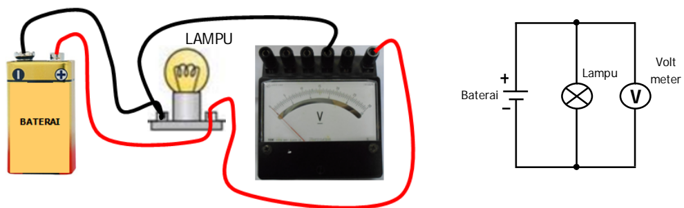
Gambar 9. Pengukuran tegangan menggunakan voltmeter
