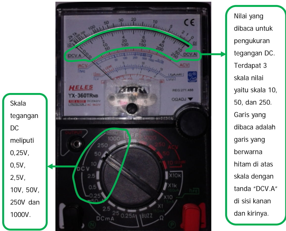
Gambar 14. Pembacaan hasil pengukuran pada skala DC V
