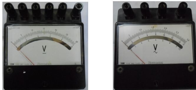
Gambar 7. Voltmeter DC (kiri) dan voltmeter AC (kanan)
