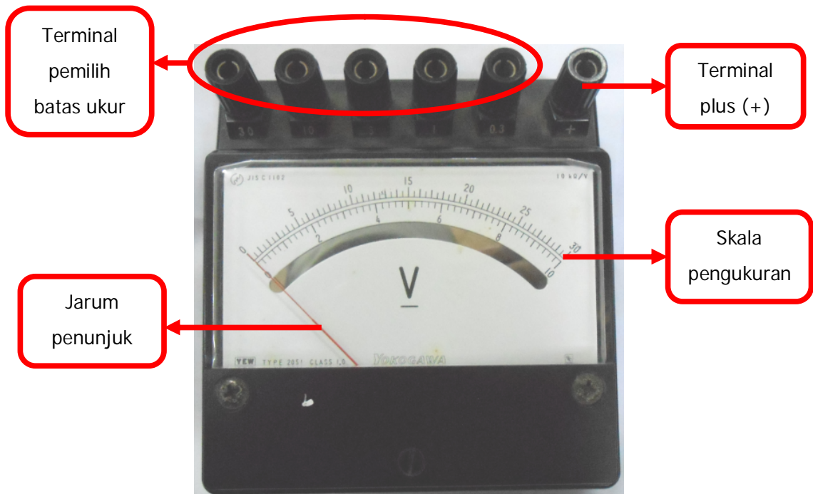
Gambar 8. Bagian-bagian Voltmeter
