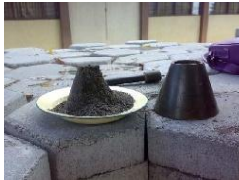
Gambar 34 . Kerucut abrams dan penumbuk
