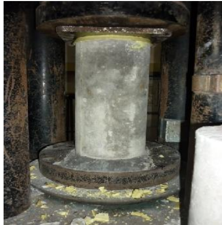
Gambar. 39 Proses uji tekan beton ringan
