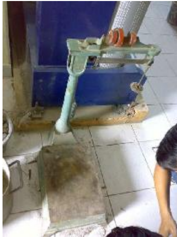
Gambar 13. Timbangan dengan kapasitas 50 kg
