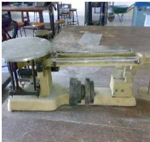
Gambar 12. Timbangan dengan kapasitas 10 kg
