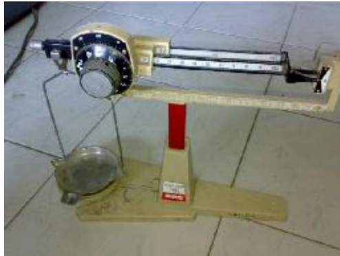
Gambar 11. Timbangan dengan kapasitas 310 gram
