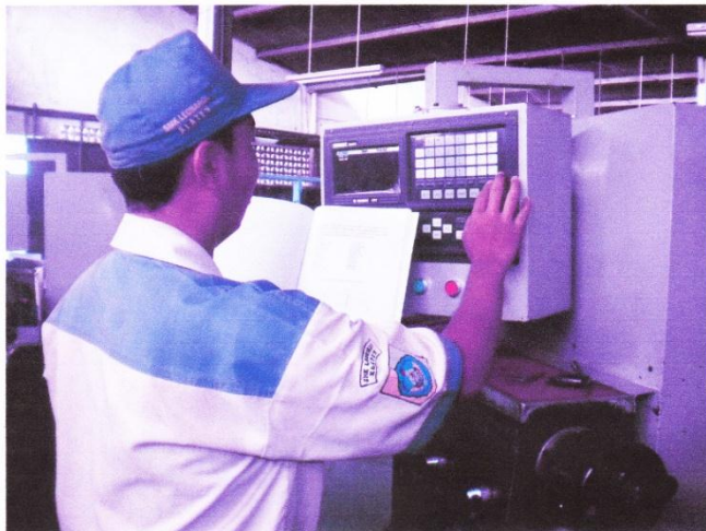
Siswa menulis program pada layar mesin bubut CNC GSK 928 TE II
