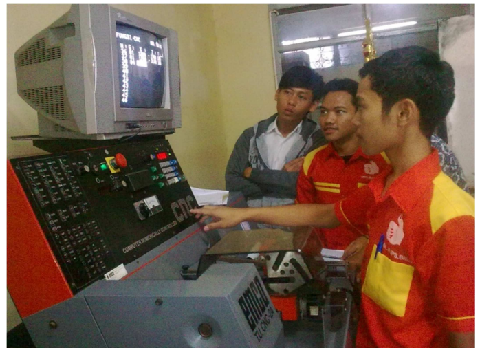
Siswa memasukan program pada mesin CNC TU 2A sesuai dengan job masing-masing.
