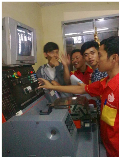
Siswa memasukan program pada mesin CNC TU 2A sesuai dengan job masing-masing.
