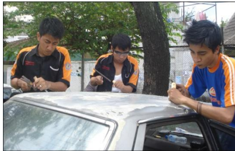
Gambar 49. Mengelupas lapisan cat menggunakan palu dan sekrap
