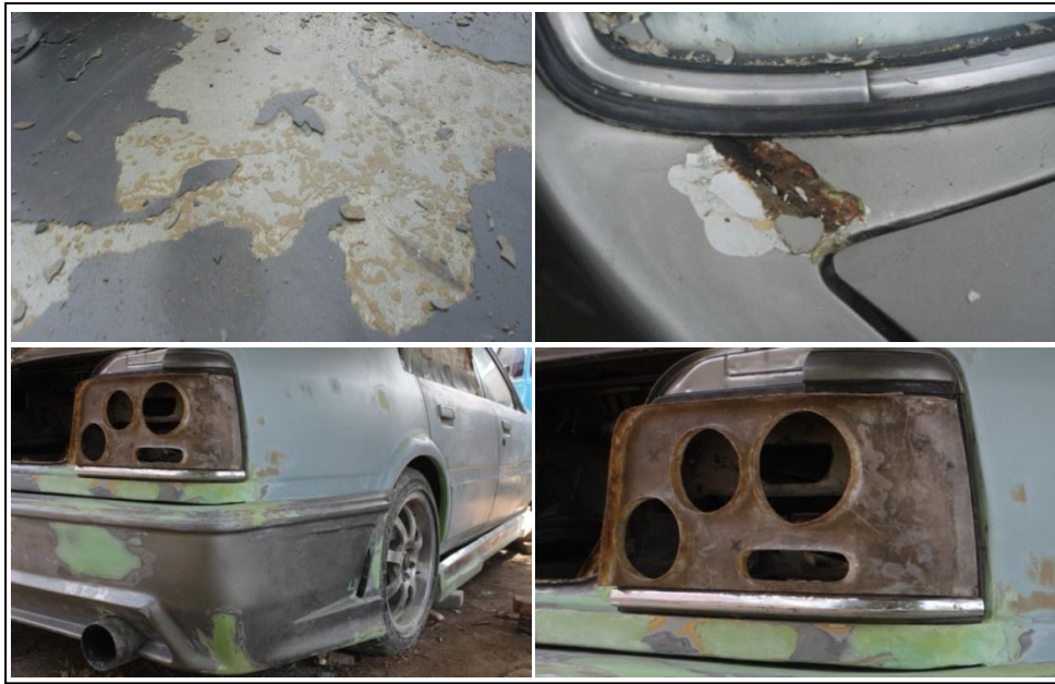
Gambar 48. Kerusakan pada bagian setengah atap belakang dan belakang
