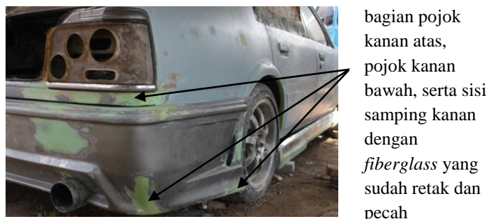
Gambar 46. Kerusakan pada bagian bumper belakang
