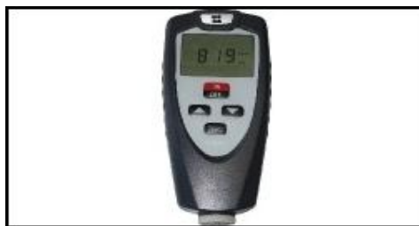
Gambar 33. Alat ukur ketebalan cat (Anonim, tth)
