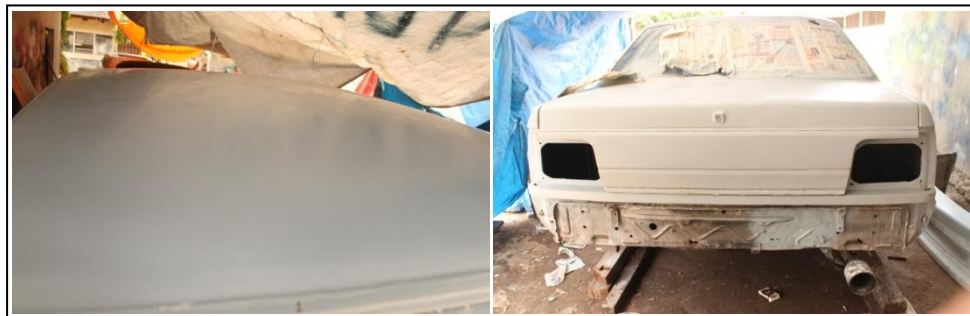
Gambar 52. Bagian atap dan belakang setelah aplikasi epoxy surfacer
