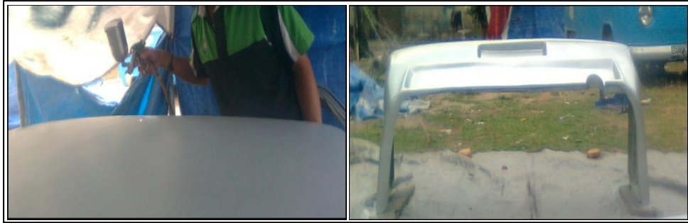
Gambar 53. Aplikasi cat warna dan bumper belakang setelah cat warna
