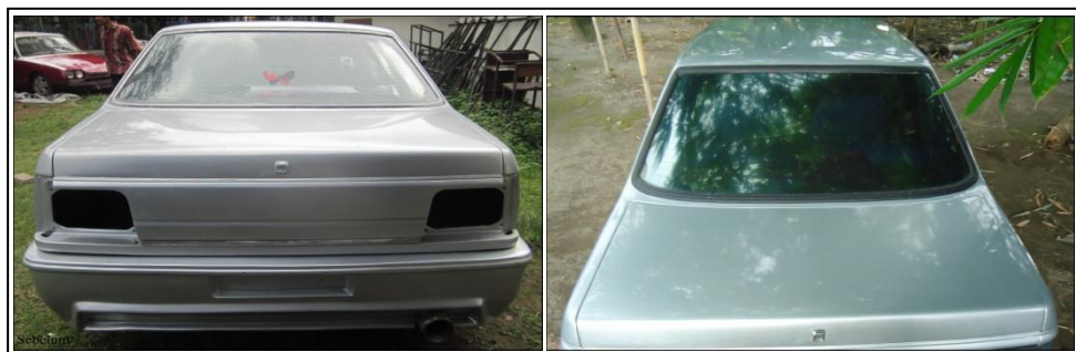
Gambar 56. Hasil pengecatan bagian setengah atap belakang dan belakang
