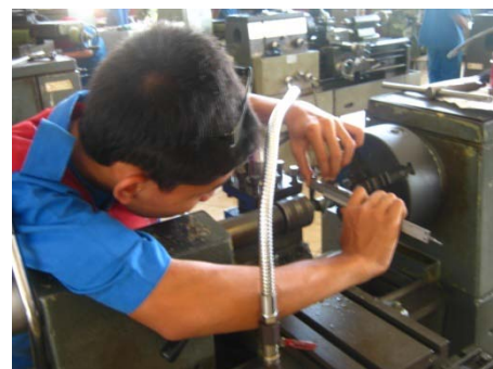
Gambar 7. Siswa melakukan pengecekan ukuran benda kerja
