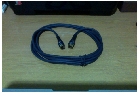
Gambar 9: Kabel midi penghubung dan Konektor (Dok : agung , Maret 2013)
