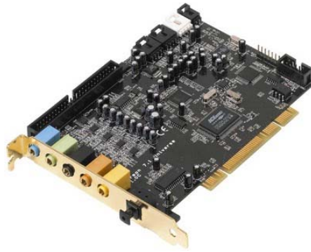
Gambar 2: Sound Card OffBoard yaitu sound card yang pemasangannya dislot PCI pada Motherboard . ( Dok : agung , Maret 2013 )
