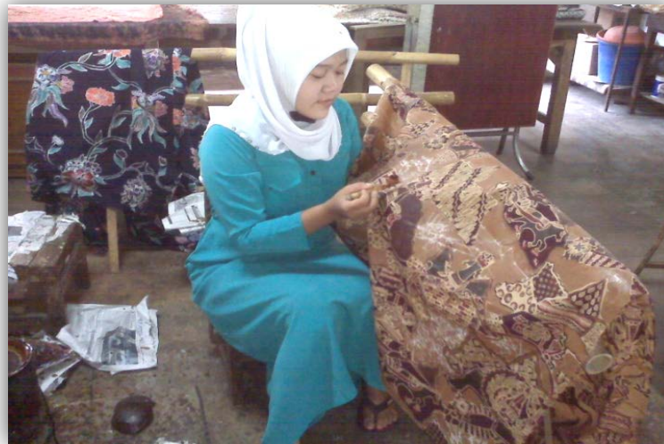
Gambar 71 : Menembok dengan menggunakan Parafin (Dokumentasi : Danti Rizki Amalia , 2014)
