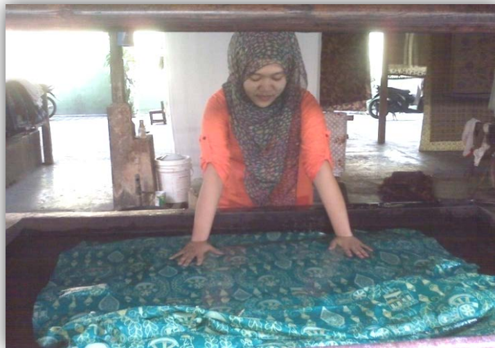
Gambar 66 : Proses fiksasi warna dengan menggunakan HCL (Dokumentasi: Danti Rizki Amalia , 2014)
