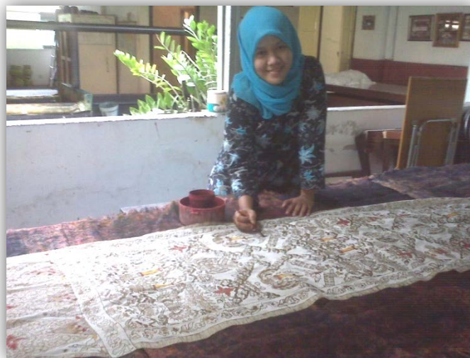
Gambar 59 : Proses pewarnaan dengan teknik colet (Dokumentasi: Danti Rizki Amalia , 2014)
