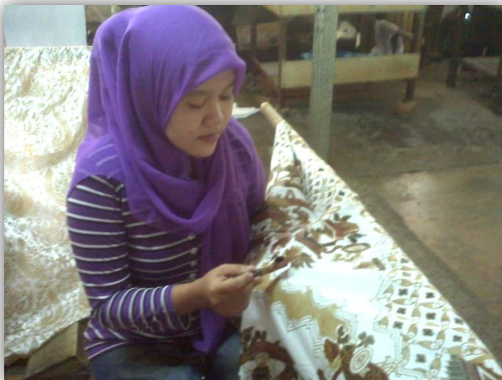
Gambar 58 : Menembok atau menutup bagian yang telah diwarnai (Sumber : Danti Rizki Amalia , 2014)
