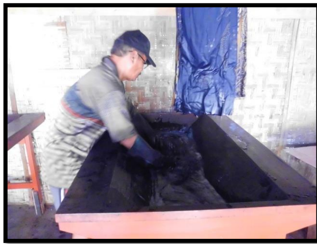
Gambar XXIV: Proses Pencelupan pada Bak Celup Garam (Sumber: Dokumentasi Muryani, Mei 2014)
