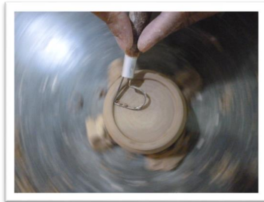
Gambar 32: Proses Pembuatan Kaki (Sumber: Dokumentasi Penulis, 2014)
