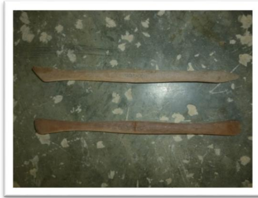
Gambar 12: Butsir Kayu ( Wood Modelling Tools ) (Sumber: Dokumentasi Penulis, 2014)
