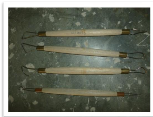
Gambar 11: Butsir Kawan (Wire Modelling Tools) (Sumber: Dokumentasi Penulis, 2014)
