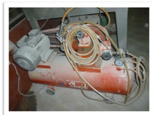
Gambar 25: Kompresor (Sumber: Dokumentasi Penulis, 2014)
