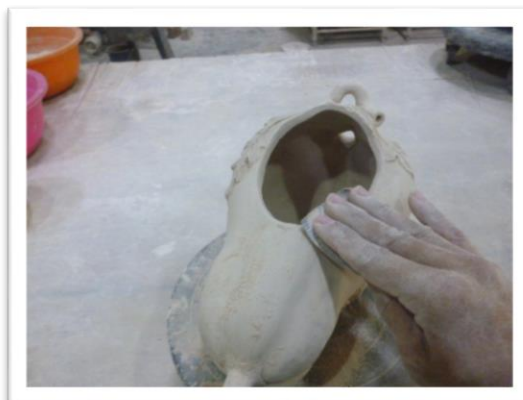
Gambar 36: Proses Pengamplasan (Sumber: Dokumentasi Penulis, 2014)
