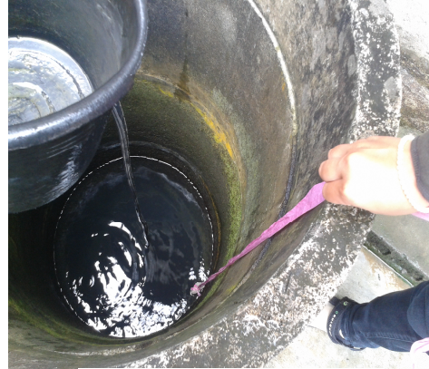
PENGUKURAN TINGGI MUKA AIR TANAH
