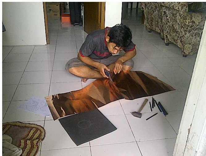
Gambar 10: Pemotongan Tembaga (Dokumentasi: Adnan, 2014)
