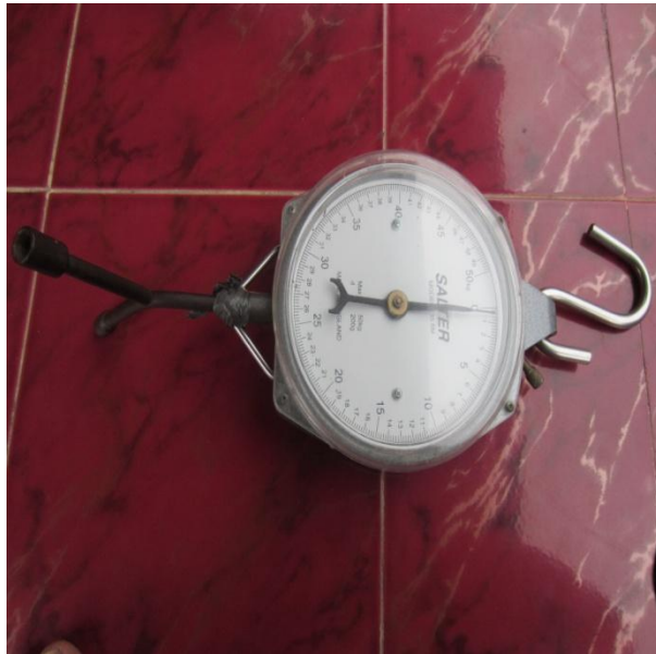
Gambar 5. Neraca Pegas ( Spring Scale ) Modifikasi
