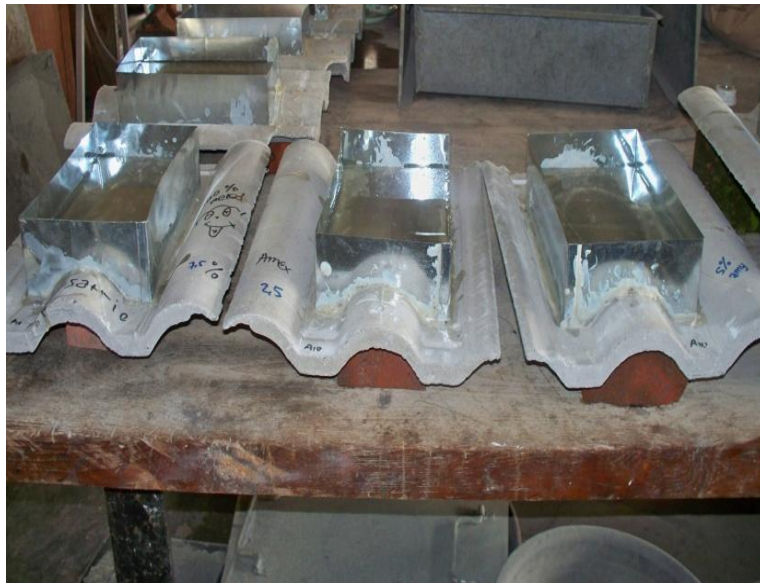
Gambar 25. Pengujian Rembesan Air ( Impermeabilitas )
