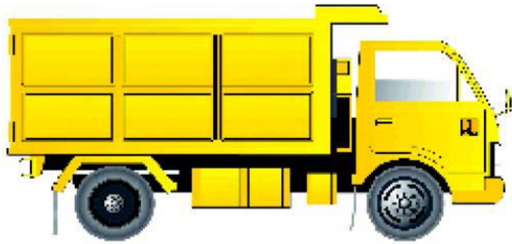
Gambar 3.1. Dump Truk dengan Kapasitas 6 m 3
