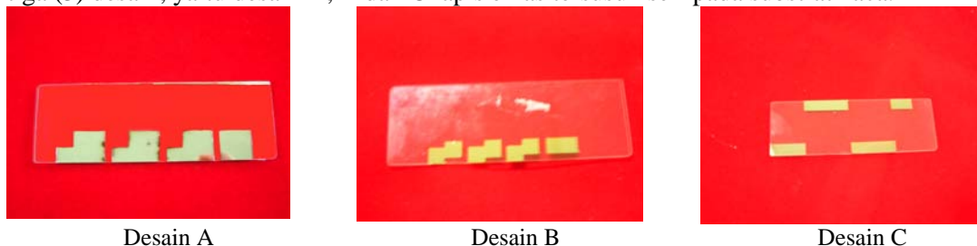
Gambar 5. Desain elektroda lawan modul dengan 3 sel surya yang dipasang seri
