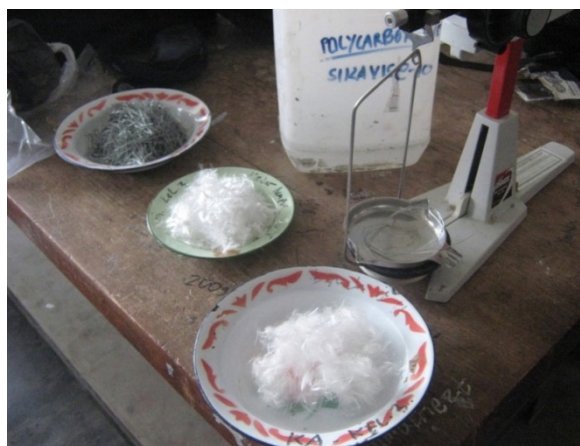
Foto 6. Serat kawat ( steel fiber/SF ) dan serat polypropylene (PP)
