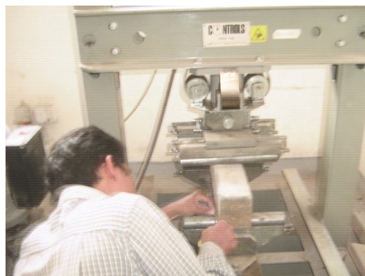
Foto 15. Mengukur persiapan pengujian kuat lentur.
