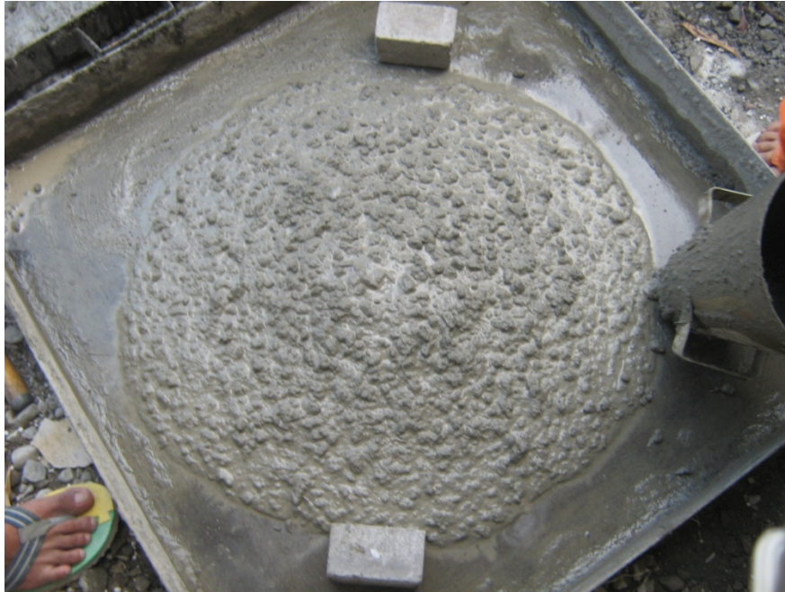
Gambar 11. Hasil pengujian slump flow
