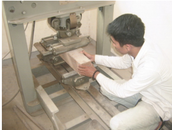
Foto 13. Pemasangan pengujian beton.
