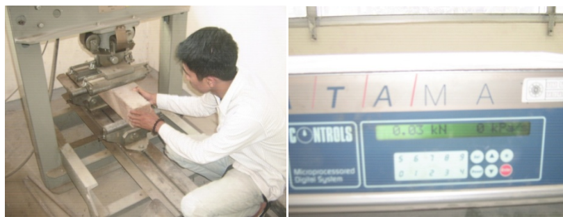
Gambar 13. Pengerjaan pengujian dan hasil pengujian kuat lentur
