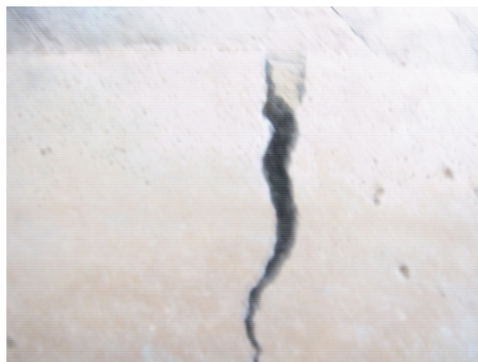
Foto 19. Hasil setelah pengujian kuat lentur.
