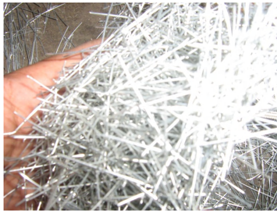
Foto 2. Hasil pemotongan Serat kawat ( steel fiber/SF )
