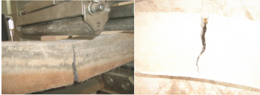
Gambar 14. Hasil Pengujian Kuat Lentur Beton HyFRSCC
