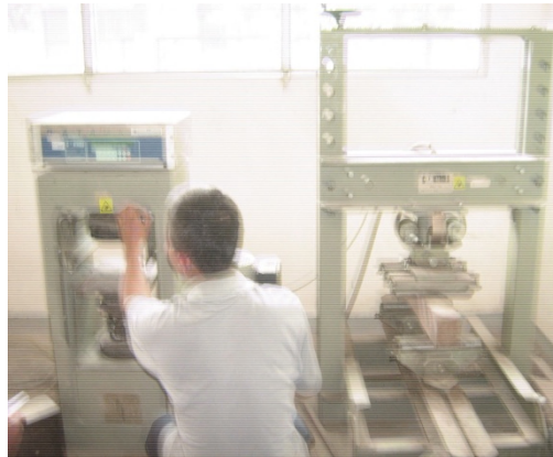
Foto 16. Proses mesin controls untuk mengetahui hasil kuat lentur P.
