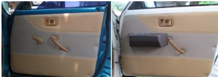
Gambar 11. Hasil modifikasi power window .
