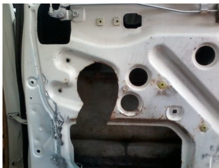
Gambar 8. profil pintu belakang sesudah di potong.
