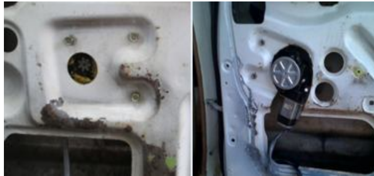
Gambar 10. Regulator motor power window terpasang pada pintu.
