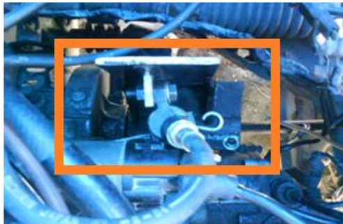
Gambar 10. Dudukan release cylinder dan release cylinder yang terpasang.
