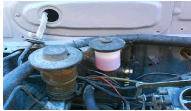
Gambar 9. Master cylinder yang telah terpasang
